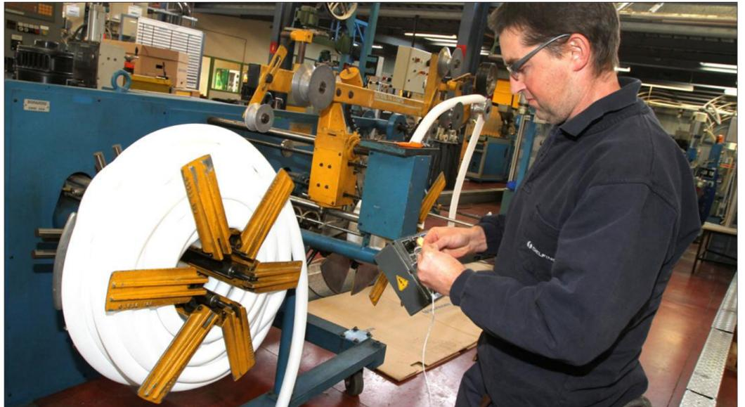
■ Les gaines sont enroulées à la sortie de la fabrication, prêtes à être expédiées.
